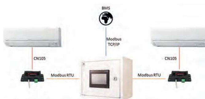
Schemat podłączenia panelu PAC-GT2104IF-E*
